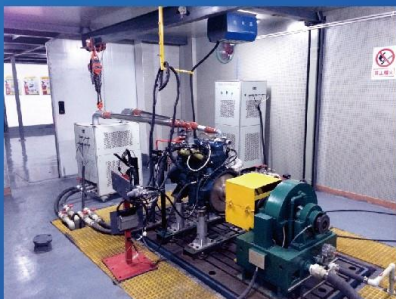
160kW电涡流测功机 160kW Eddy Current Dynamometer
