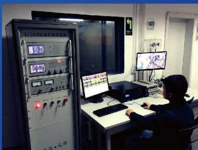
400kW电涡流测功机 400kW Eddy Current Dynamometer
